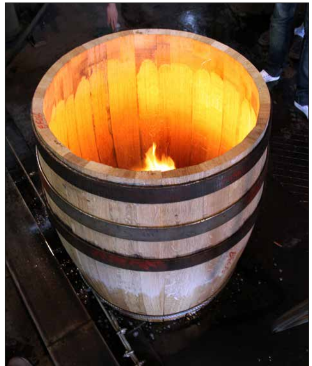
Chauffe d'un tonneau avec un brasero, et serrage à l'aide d'un câble d'acier se resserrant progressivement en bas- Olivier Colas
