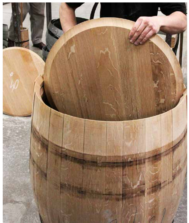
Pose de la pièce de fond d'un tonneau - Olivier Colas
