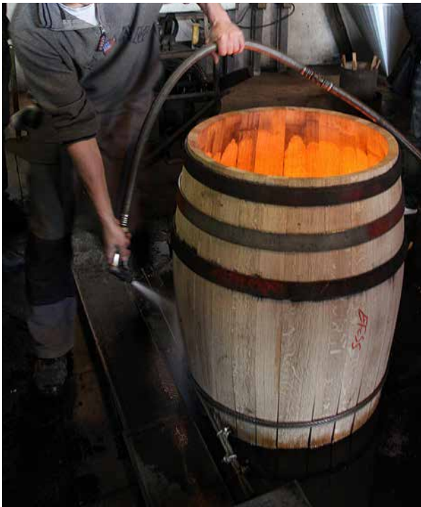
Chauffe au brasier d'un tonneau et cerclage du bas - Olivier Colas
